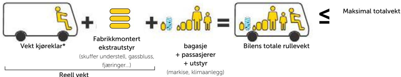
\*Vekt kjøreklar er det samme som bilens vekt med en drivstofftank som er fylt opp 90 %, 20 liter ferskvann og en gassflaske som er 90 % full, medregnet førerens vekt (75 kg) og bilens standardutstyr.
