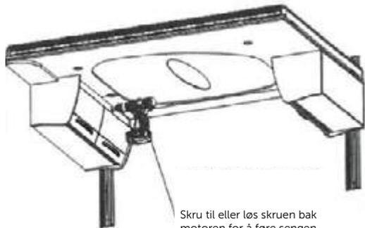
Skru til eller løs skruen bak motoren for å føre sengen opp eller ned
