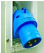
A ligação à rede elétrica é feita através de um cabo que é ligado à tomada azul P17 da autocaravana. Esta tomada está localizada diretamente na parede do veículo ou no compartimento técnico acessível através de um postigo.
