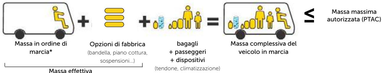
\*La massa in ordine di marcia corrisponde alla massa del veicolo con il serbatoio del carburante riempito al 90%, 20 litri di acque chiare e una bombola del gas riempita al 90%, compresa la massa del conducente (75 kg) e gli apparecchi di serie del veicolo.
