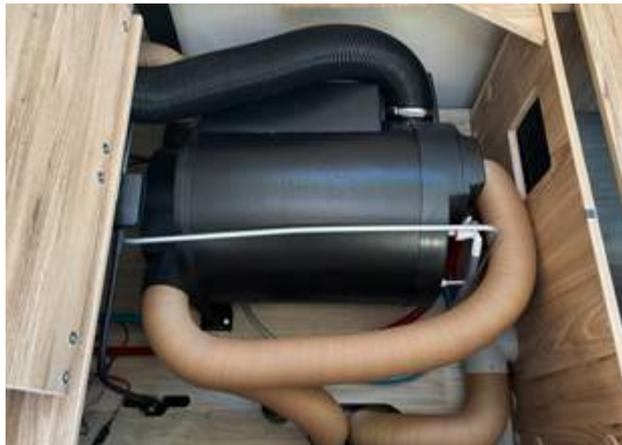
Admisión de aire y salida de los gases de combustión
