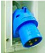
Der Anschluss an das Stromnetz erfolgt über ein Kabel, das am Wohnmobil an die blaue Steckdose P17 angeschlossen wird. Die Steckdose befindet sich an der Außenseite der Fahrzeugwand oder im technischen Raum, der über eine Klappe zugänglich ist.
