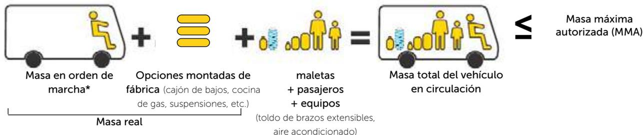
\*La masa en orden de marcha incluye la masa del vehículo con el depósito de combustible lleno al 90%, 20 litros de agua limpia, una botella de gas llena al 90%, el peso del conductor (75 kg) y los equipos de serie del vehículo.
