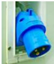
La conexión con la red eléctrica se realiza por medio de un cable que hay que conectar a la autocaravana al enchufe azul P17. Se encuentra, o bien directamente en la pared del vehículo, o bien en un recinto técnico accesible a través de una puerta.
