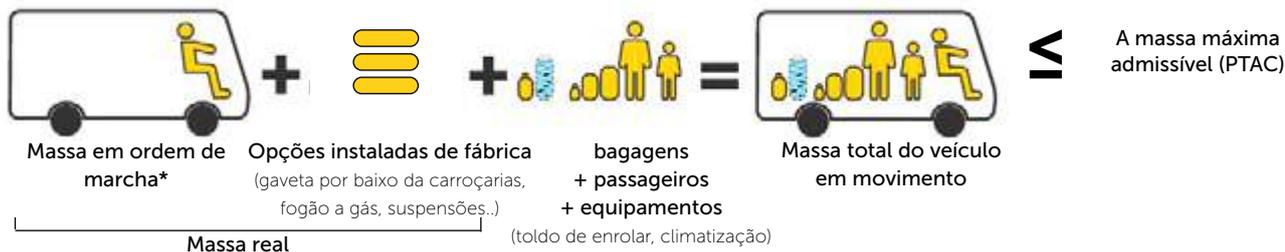
\*A massa em ordem de marcha corresponde à massa do veículo com o depósito de combustível cheio a 90%, 20 litros de água limpa e uma garrafa de gás cheia a 90%, incluindo a massa do condutor (75 kg) e o equipamento standard do veículo.
